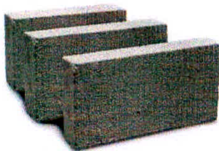
Figura 09: Blocos de concreto celular autoclavado. Fonte: Precon.
