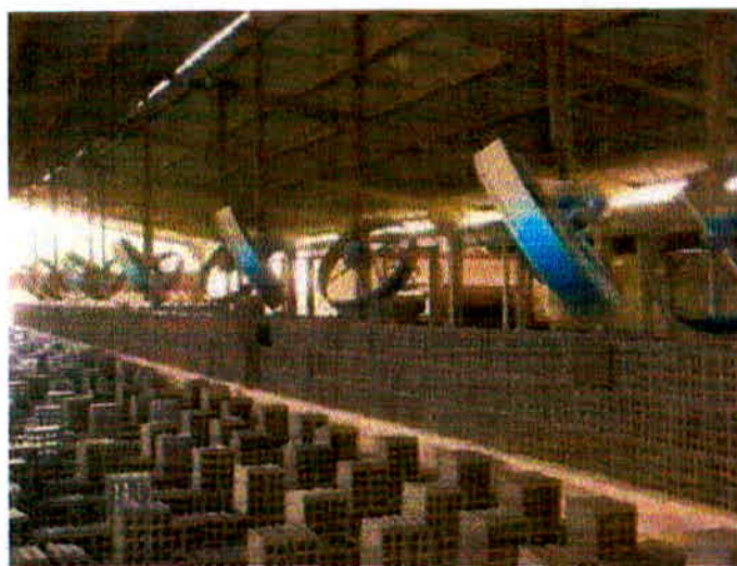
Figura 07: Secagem artificial de blocos cerâmicos. Fonte: SENAI S – SP 2007.
