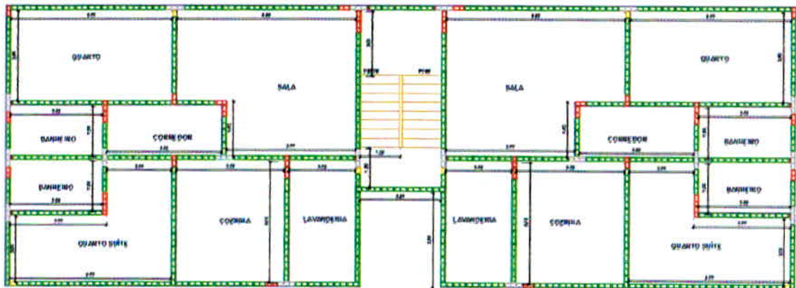
Figura 46 - Modulação da fiada par do bloco convencional.
