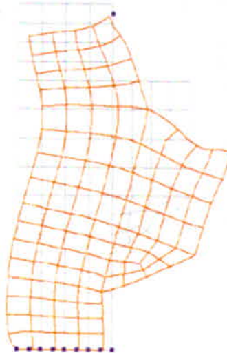
Figura 8 – estrutura com previsão aproximada de deformação
