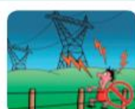
Não utilize cercas eletrificadas na faixa de servidão
