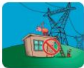
Não construa nenhum tipo de moradia na faixa de servidão
