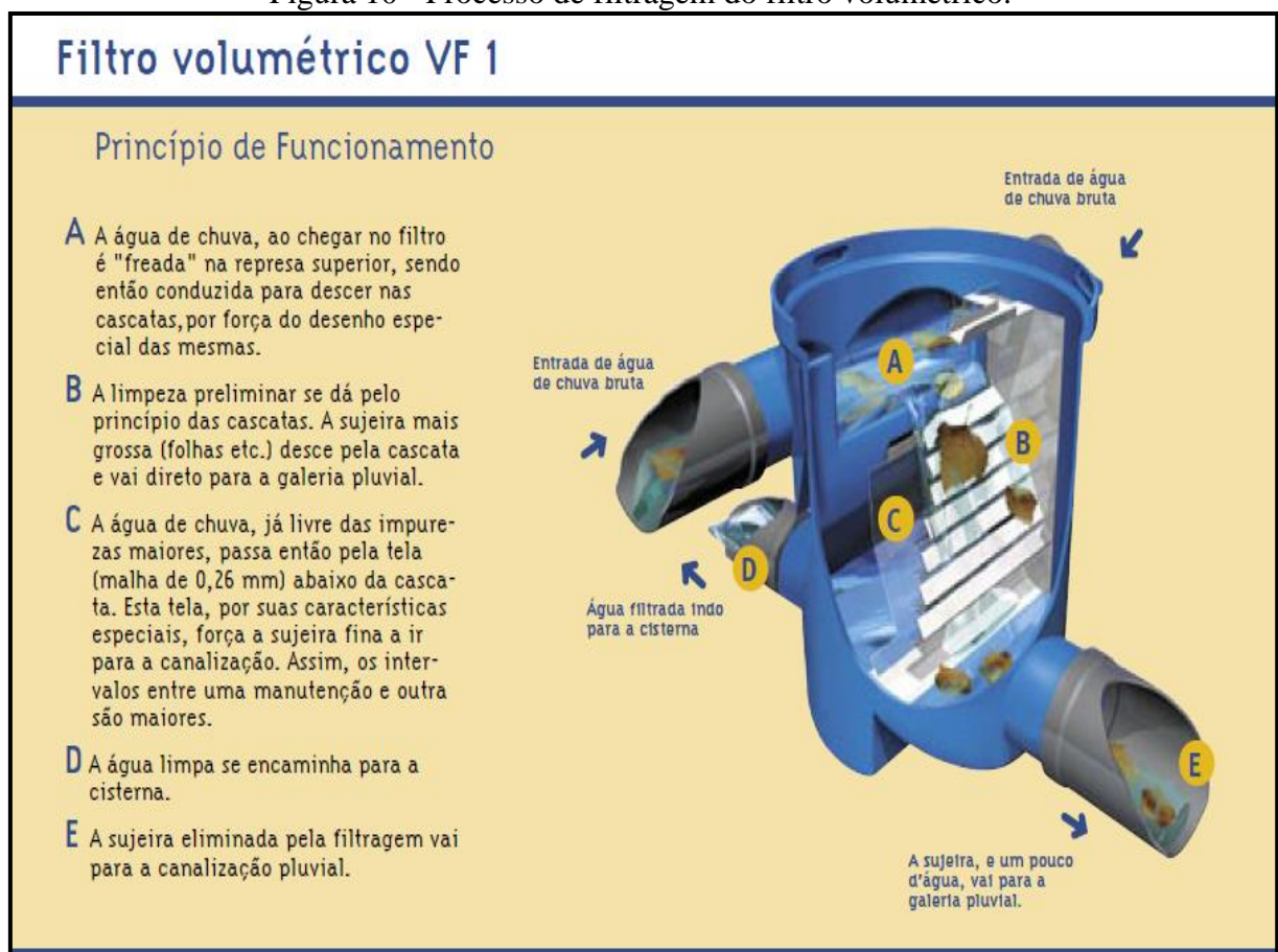
Figura 10 - Processo de filtragem do filtro volumétrico.
