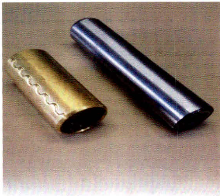
Figura 15: Bucha de Bronze e Pino ainda não Instalados - Equipa Chassi OF 1721 da Mercedes Benz
