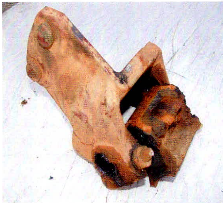
Figura 13: Suporte Jumelo de um Feixe de Molas – Com Jumelo Quebrado
