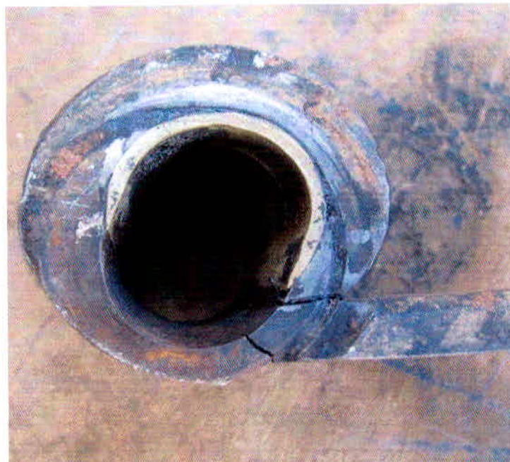
Figura 10: Ponta (Olhete) da Lâmina Principal de um Feixe de Molas (a) – Extremamente Danificado
