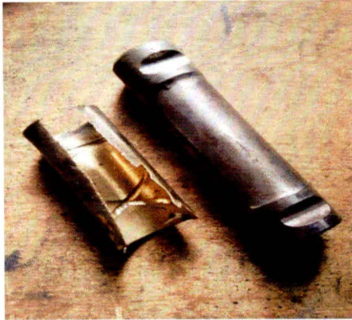
Figura 12: Bucha de Bronze e Pino Desgastados - Equipa Chassi OF 1721 da Mercedes Benz
