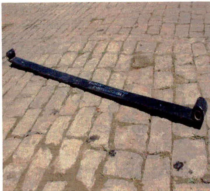
Figura 3: Lâmina Principal de um Feixe de Molas Semi-elípticas - Equipa Chassi OF 1721 da Mercedes Benz
