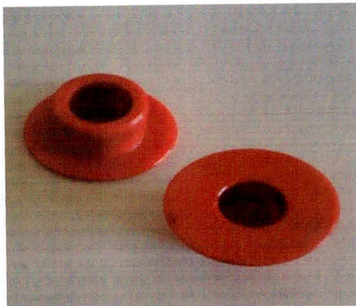
Figura 16: Buchas de Polipropileno ainda não Instaladas - Equipara Chassi OF 1721 da Mercedes Benz
