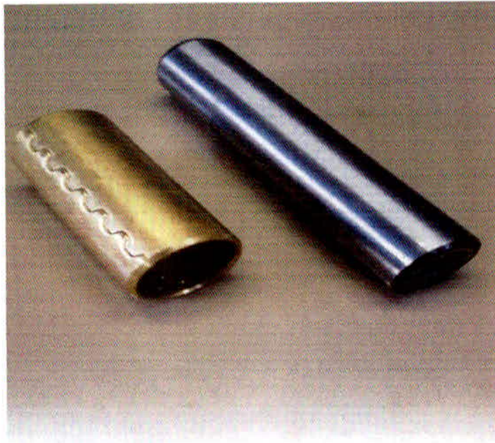
Figura 5: Bucha de Bronze e Pino ainda não Instalados - Equipa Chassi OF 1721 da Mercedes Benz
