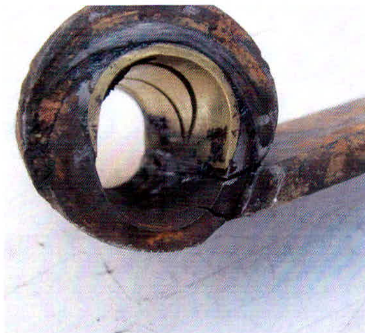
Figura 11: Ponta (Olhete) da Lâmina Principal de um Feixe de Molas (b) – Extremamente Danificado
