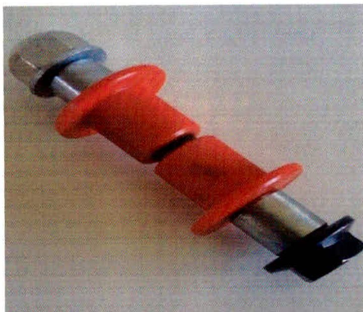
Figura 17: Buchas de Polipropileno e Pino ainda não Instalados - Equipara Chassi OF 1721 da Mercedes Benz
