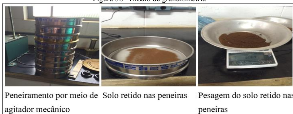
Figura 56 - Ensaio de granulometria
