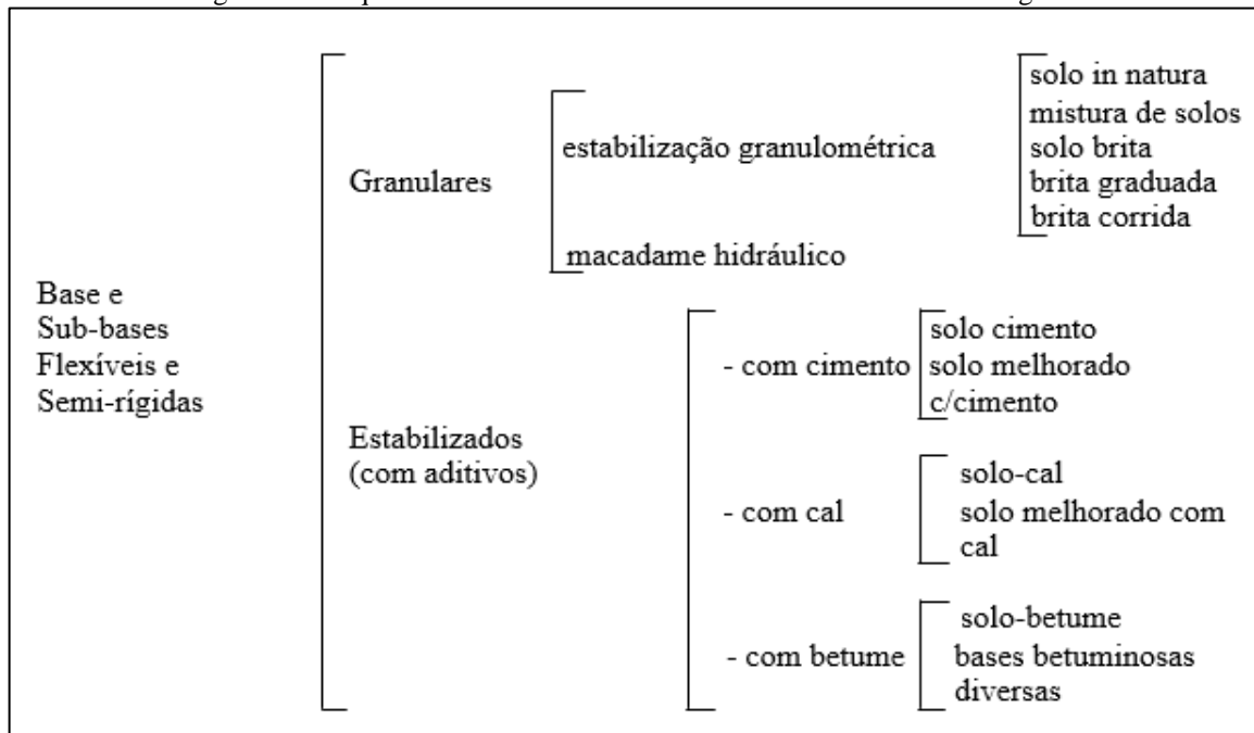
Figura 15 - Esquema de divisão de bases e sub-bases flexíveis e semi-rígidas
