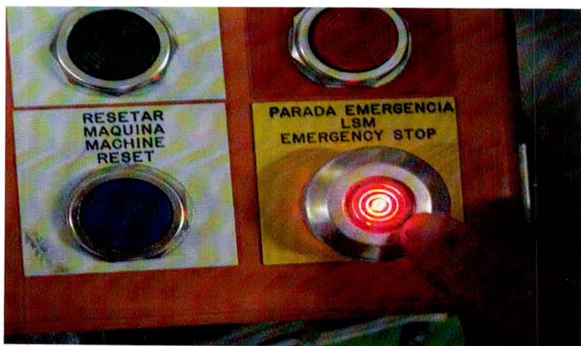
Figura 09: Botão acionado parando a máquina. FONTE: Celso Luis Carvalho Júnior, Inside Spray , Rexam, 2011.
