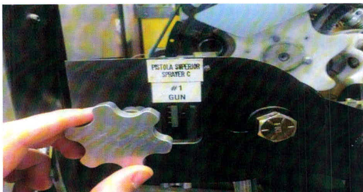
Figura 15: Fuso de ajuste de distância do bico da pistola com a lata. FONTE: Celso Luis Carvalho Júnior, Inside Spray, Rexam, 2011.
