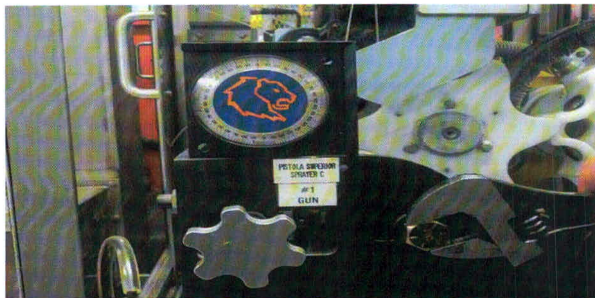
Figura 14: Medidor de nivelamento acusando exatamente 0^\circ , pistola nivelada. FONTE: Celso Luis Carvalho Júnior, Inside Spray , Rexam, 2011.
