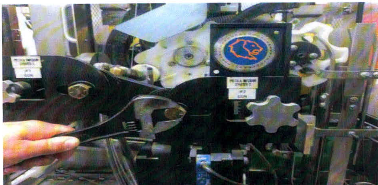
Figura 13: Fuso para nivelar as pistolas. FONTE: Celso Luis Carvalho Júnior, Inside Spray , Rexam, 2011.
