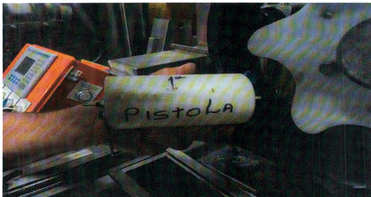
Figura 11: Gabarito da 1ª pistola para ajuste. FONTE: Celso Luis Carvalho Júnior, Inside Spray , Rexam, 2011
