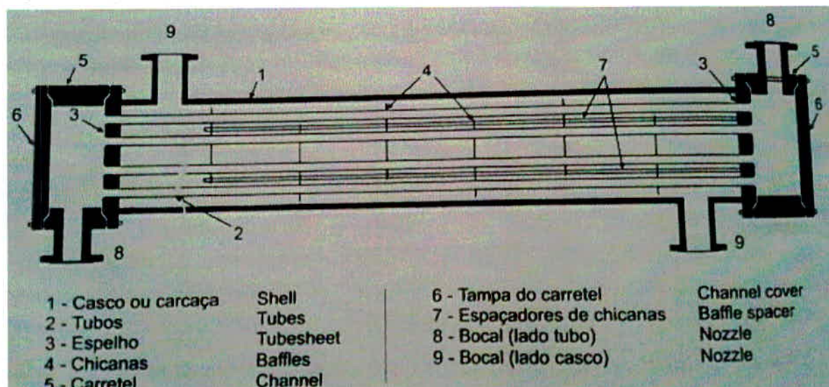
Figura 5: Componentes de um trocador de calor casco e tubo
