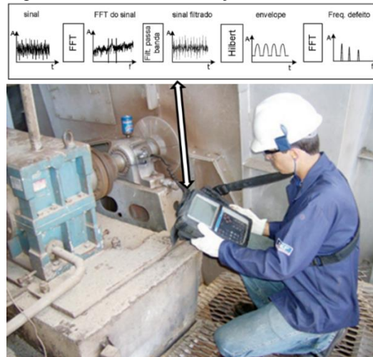
Figura 11 - Análise de vibração em mancal de rolamento.
