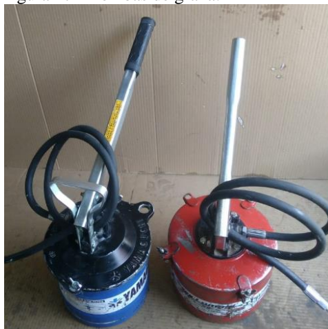
Figura 17 - Bombas de graxa.
