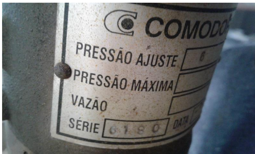
Figura 11: Primeira - Válvula de Segurança 6Kgf/cm 2 /Comodoro VS-100, diâmetro de 1 ½'' Fonte: O Autor, 2019.
