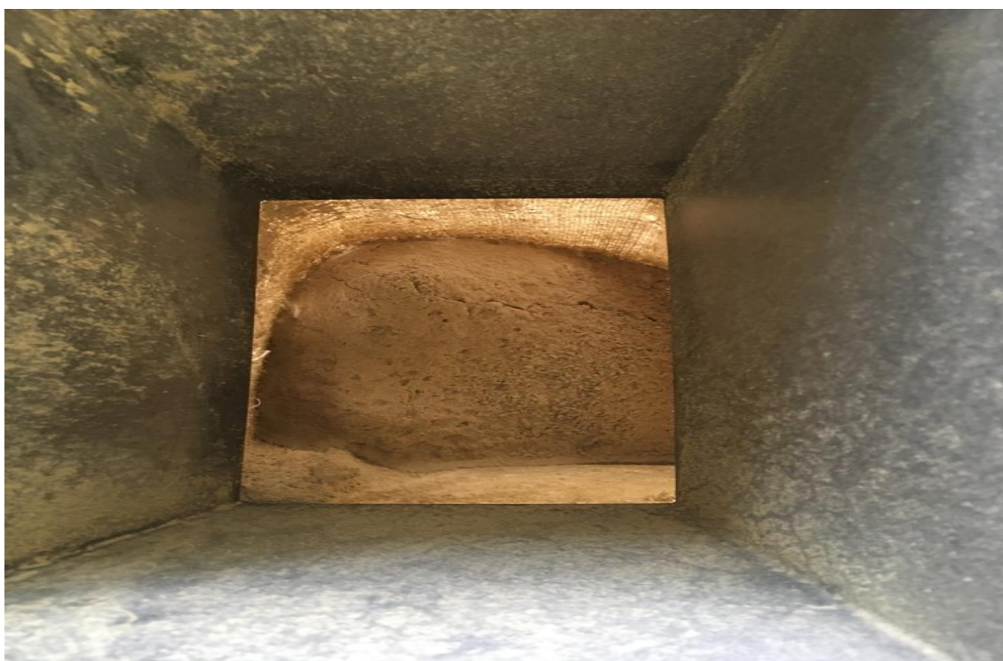
Figura 21: Poeira proveniente do café separada pela pré-limpeza.
