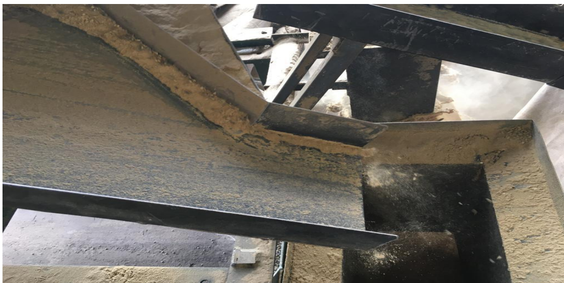
Figura 17: Bica de resíduo com suporte para ensacar a poeira.
