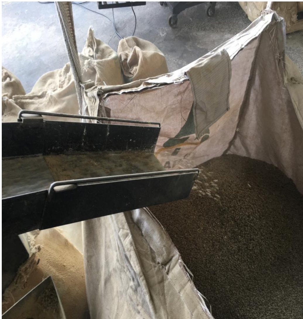
Figura 10: Café limpo saindo pela bica da pré - limpeza
