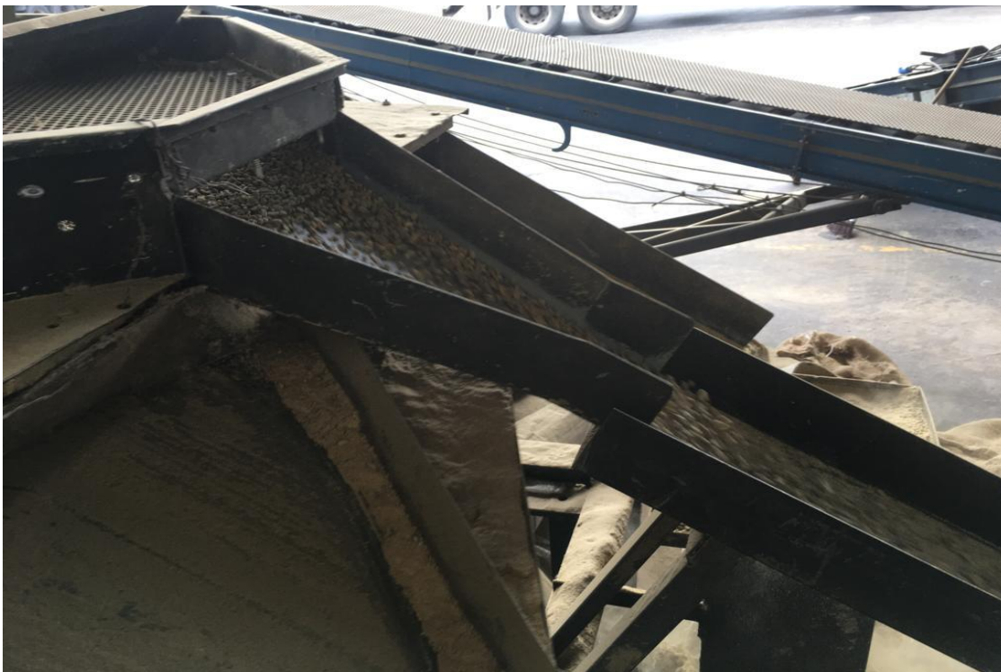
Figura 18: Saída de café limpo da pré-limpeza.
