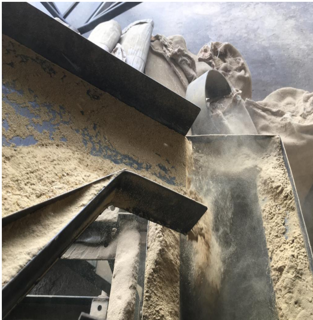
Figura 11: Pó existente no café saindo pela bica de resíduo.
