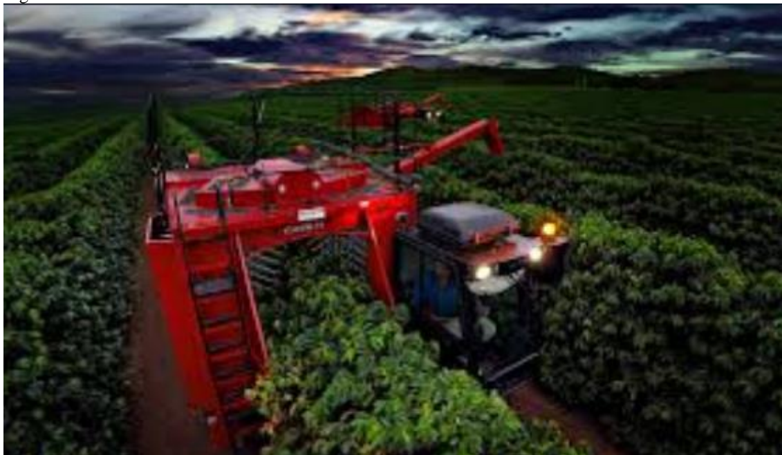
Figura 02 – Colheita do café mecanizada.
