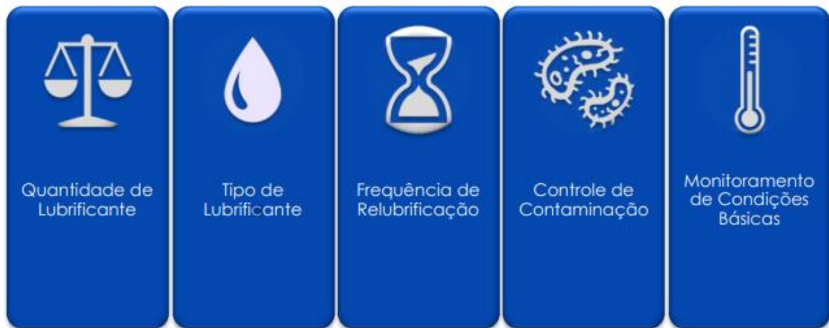
Figura 14- 5 Pilares para um bom plano de lubrificação
