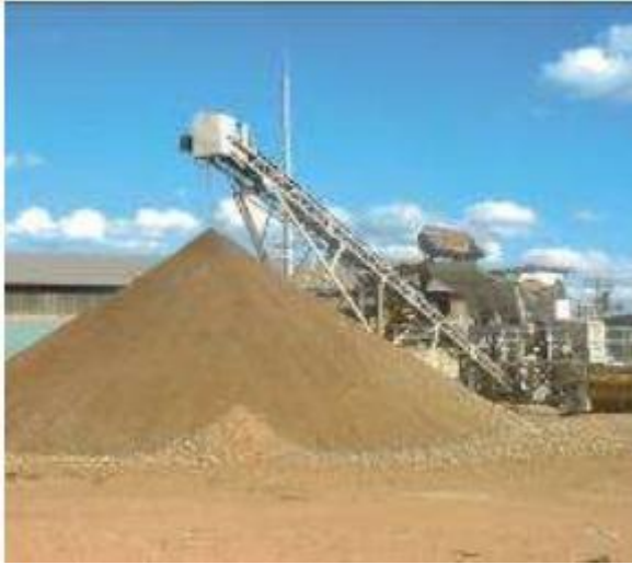
Figura 4: Entulho processado usado para tapar buracos e na criação de artefatos de cimento.
