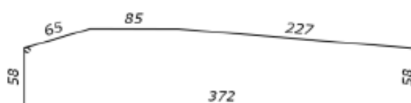
DETALHE ARMADURAS FLEXÃO SAPATA
