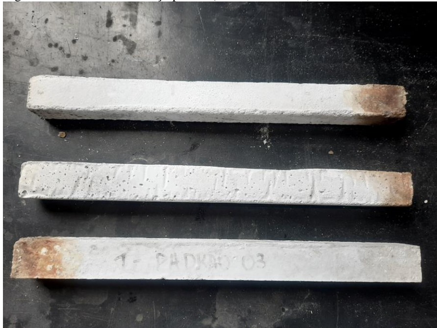
Figura 35 - Análise visual traço padrão (CPV + Areia IPT).
