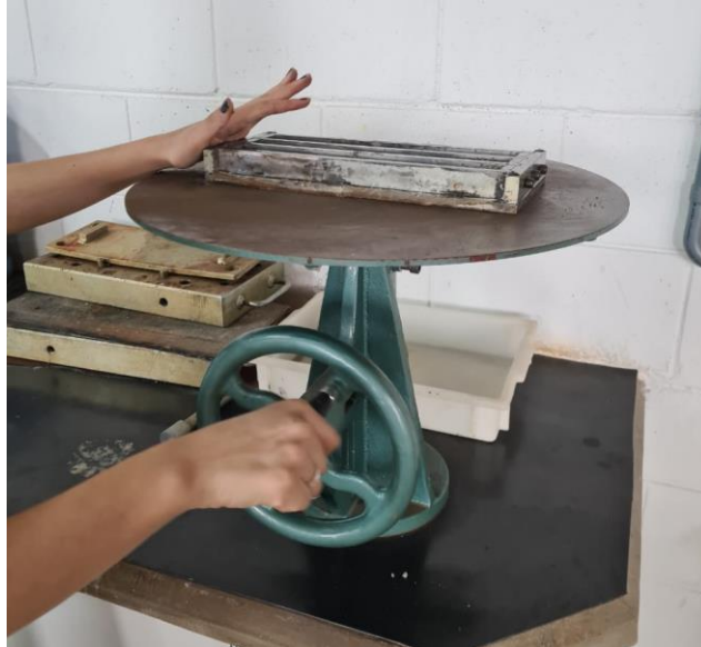
Figura 27 - Mesa de espalhamento utilizada no adensamento das barras de argamassa.
