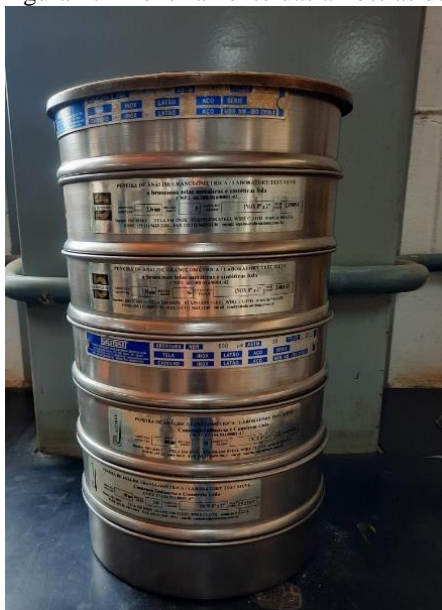
Figura 17 - Peneiramento das amostras de quartzito.
