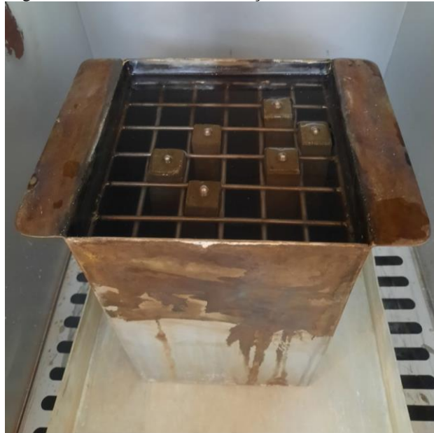
Figura 31 - Barras imersas a solução de NaOH.
