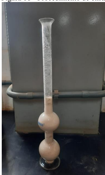
Figura 18 - Procedimento de ensaio, Frasco de Chapman.
