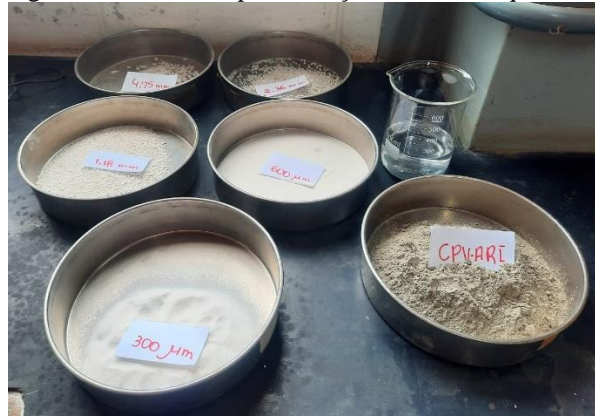
Figura 24 - Materiais para o traço CPV ARI + quartzito.
