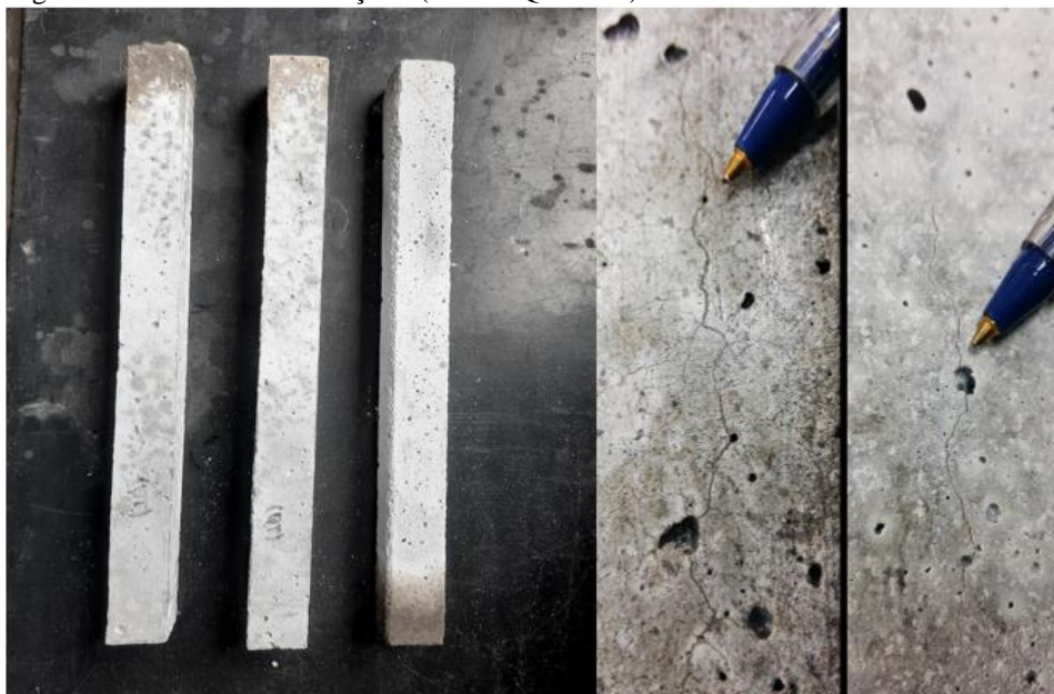
Figura 36 - Análise visual traço 1 (CPV + Quartzito).
