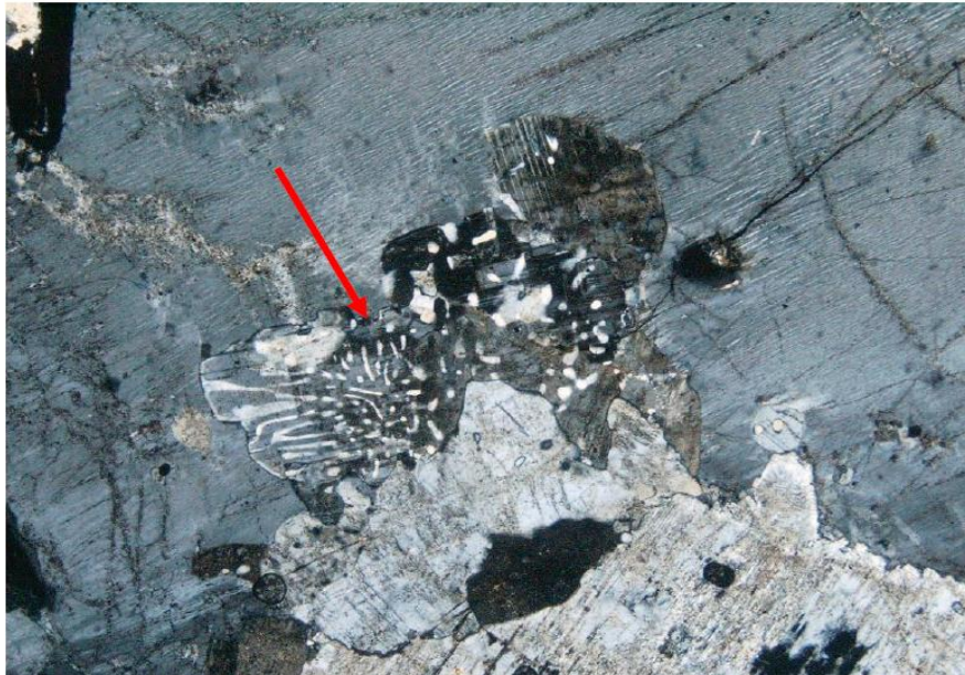
Figura 10 - Textura de exsolução do tipo mirmequita, indicado pela seta vermelha. Notar o quartzo vermicular ou "em gotas" do quartzo, característico das mirmequitas.
