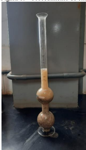
Figura 19 - Procedimento de ensaio, Frasco de Chapman.
