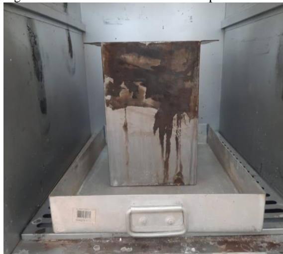
Figura 32 - Barras na estufa a uma temperatura de 80\pm 2^\circ\text{C} .
