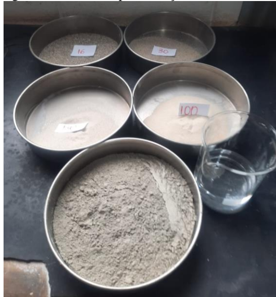
Figura 25 - Materiais para o traço CPV ARI + Areia IPT.
