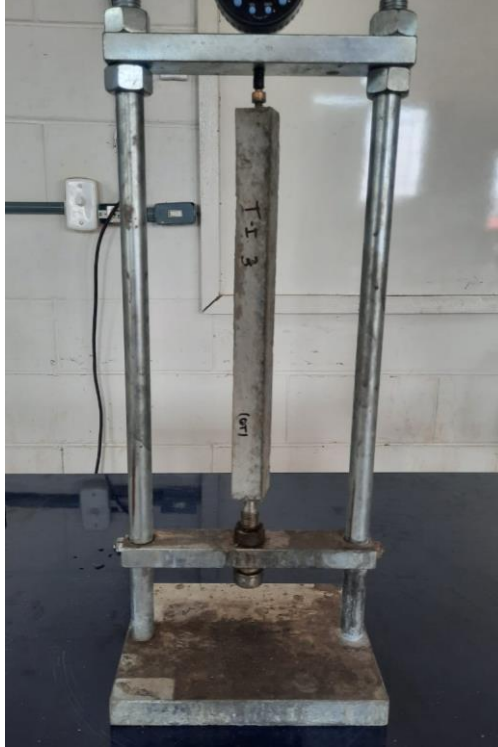
Figura 33 - Leituras realizadas no relógio comparador.
