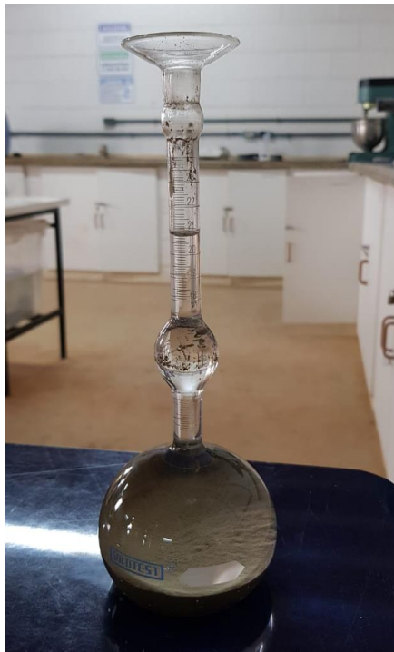
Figura 15: Ensaio da massa específica do cimento.
