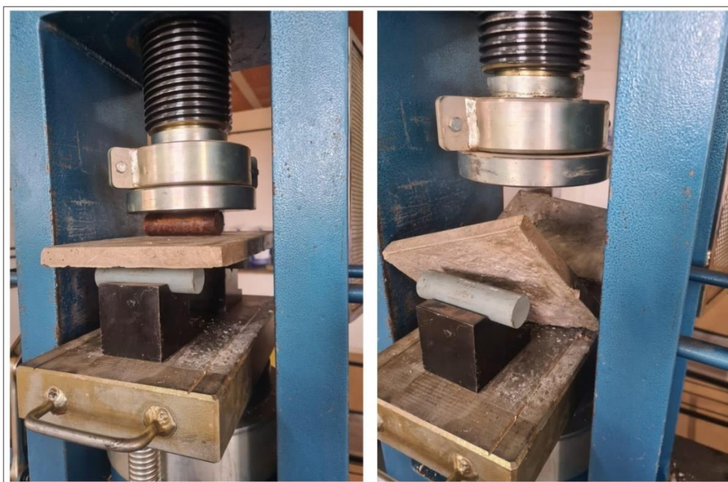
Figura 23: Ensaio de ruptura à flexão.
