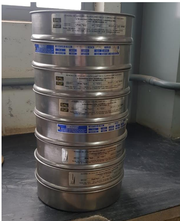
Figura 13: Série de peneiras utilizadas no ensaio de granulometria.
