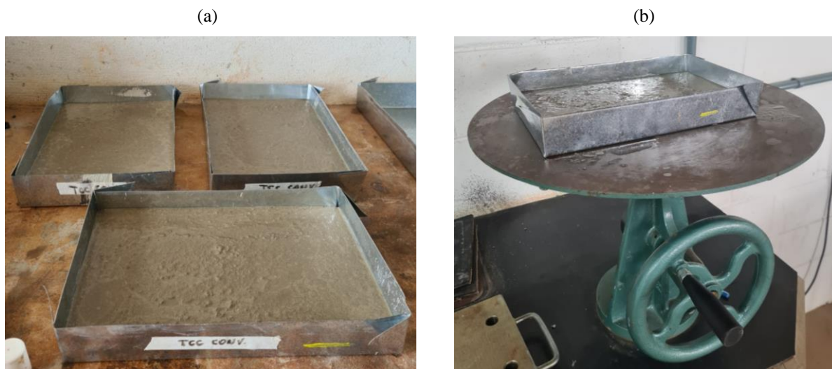
Figura 18: (a) placas retangulares moldadas e (b) mesa adensadora utilizada.
