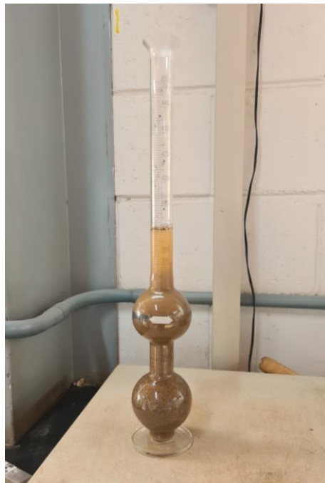
Figura 14: Ensaio de massa específica do agregado miúdo.
