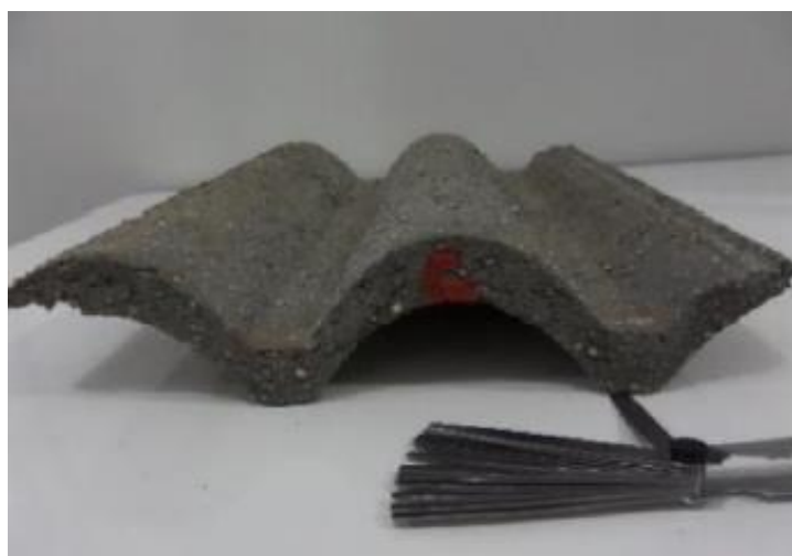
Figura 03: Ensaio de empenamento.
