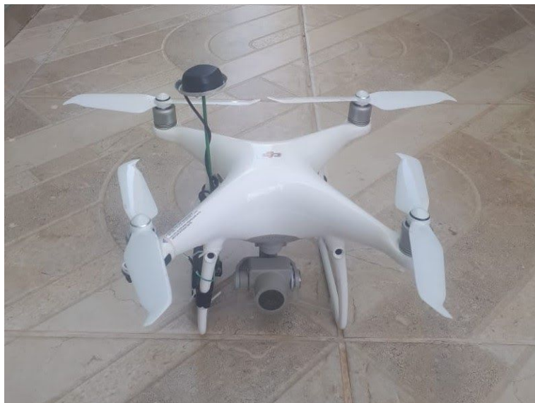
Figura 1: DJI Phantom 4 Pro V2.0 equipado com GPS/GNSS Emlid M+.
