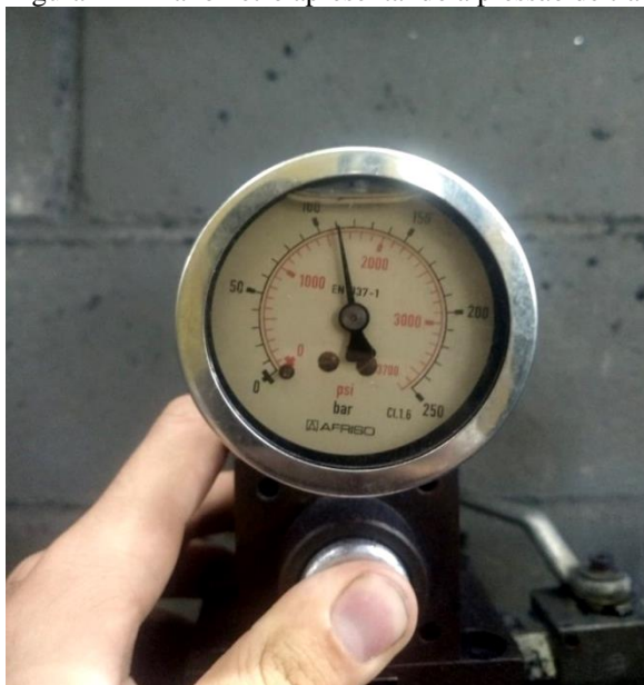
Figura 12 - Manômetro apresentando a pressão de trabalho
