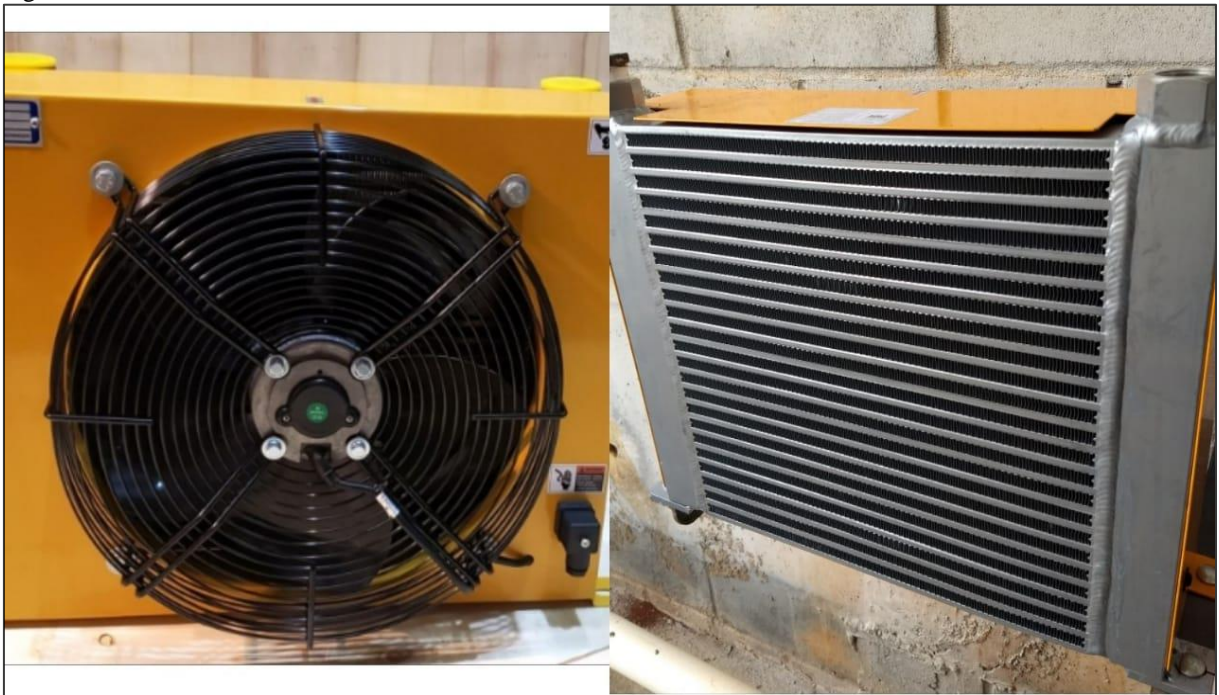
Figura 13 - Resfriador de óleo industrial
