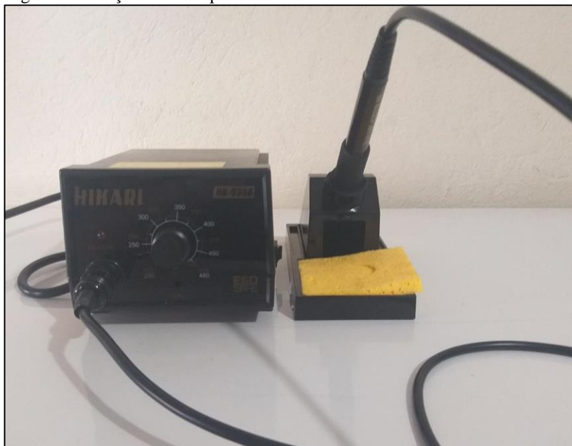
Figura 8 - Estação de solda profissional Hk-936 a Hikari
