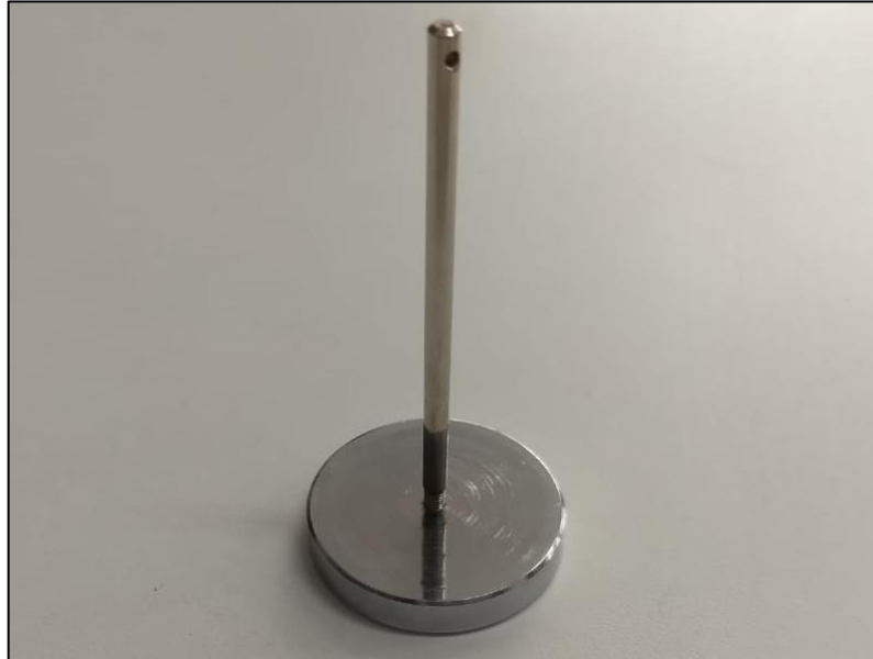
Figura 12 - Peso de 50g fixado com a haste
