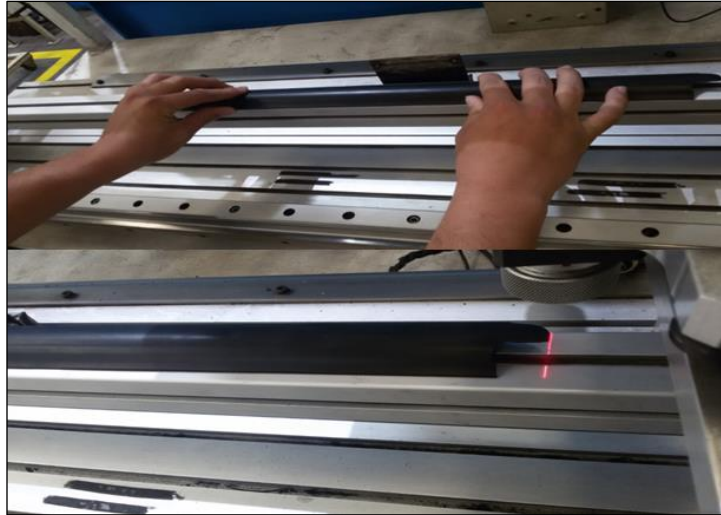
Figura 06 - Medição das amostras com trena a laser
