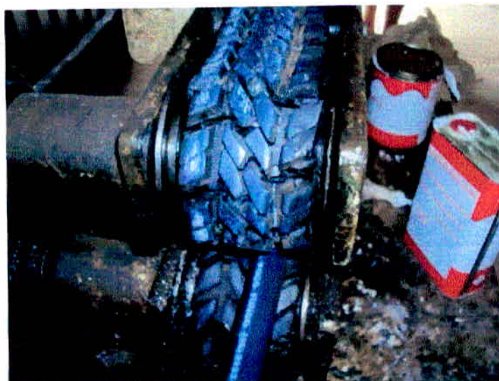
Foto.6 – Entrada do Tubo nas lagartas Equipamento Antigo
