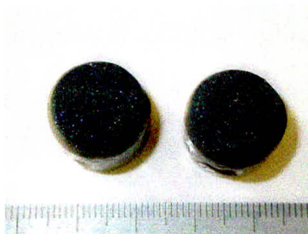
Figuras 18. Aspectos do corpo de prova Clapós o ensaio de cavitação. Fonte: CEMIG - Gerência de Manutenção mecânica da Geração.
