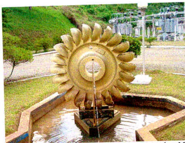
Figura 1. Rotor Pelton desativado PCH São Bernardo – MG. Fonte: o autor.
