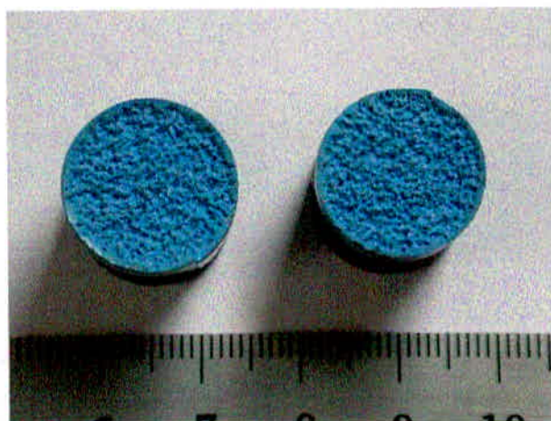
Figuras 15. Aspectos do corpo de prova D1 após o ensaio de cavitação. Fonte: CEMIG - Gerência de Manutenção mecânica da Geração.
