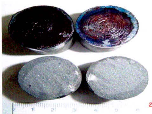
Figura 21. Corpos de prova após o ensaio de tração. Fonte: CEMIG - Gerência de Manutenção mecânica da Geração.
