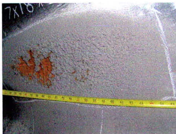
Figura 7. Erosão ocasionada por cavitação em rotor Francis. Fonte: CEMIG – Gerência de Manutenção mecânica da Geração.
