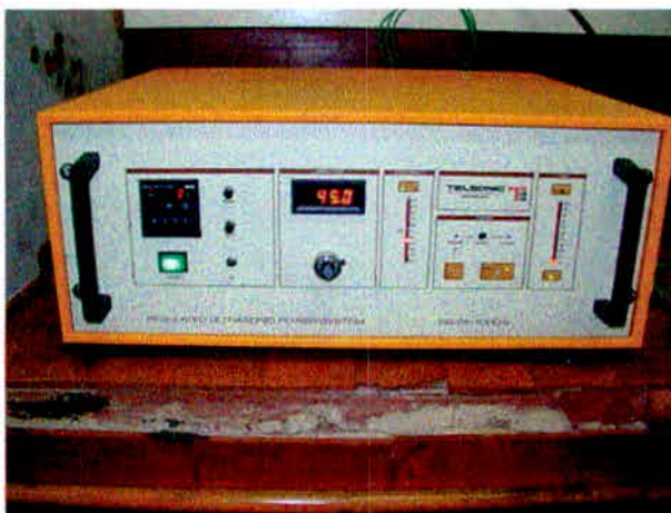
Figura 13. Equipamento para ensaio de cavitação TELSONIC console e painel de controle. Fonte: CEMIG - Gerência de Manutenção mecânica da Geração.
