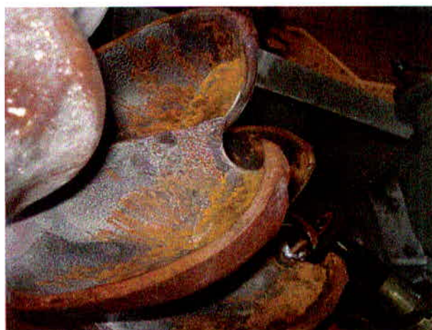
Figura 8. Cavitação em conchas de Rotor Pelton. PCH São Bernardo – MG. Fonte: o autor.
