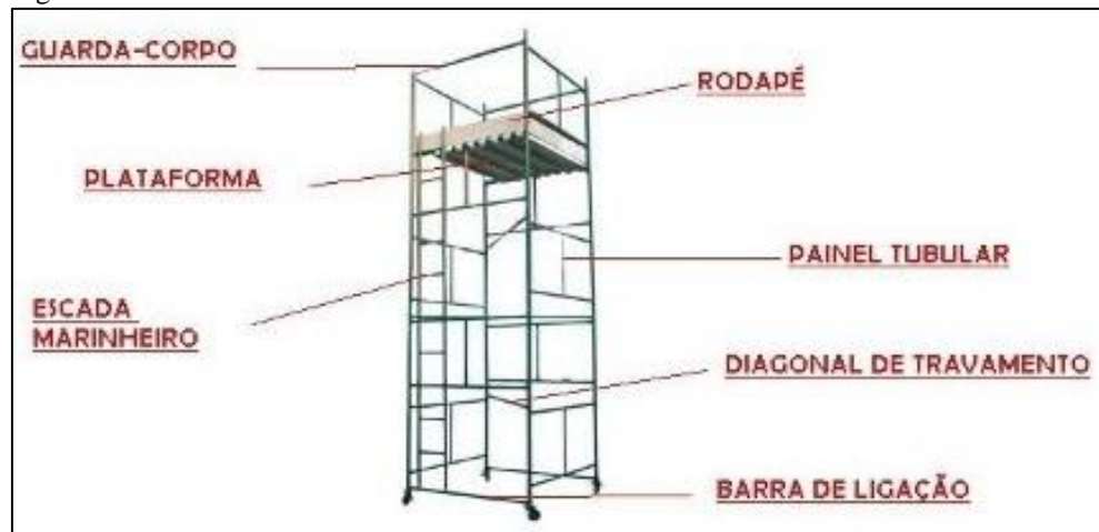
Figura 6 – Andaime tubular convencional
