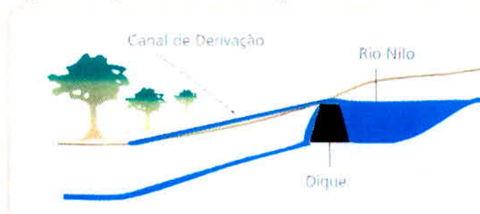
Figura 3 - Esquema de Desvio da Água do Rio Nilo.
