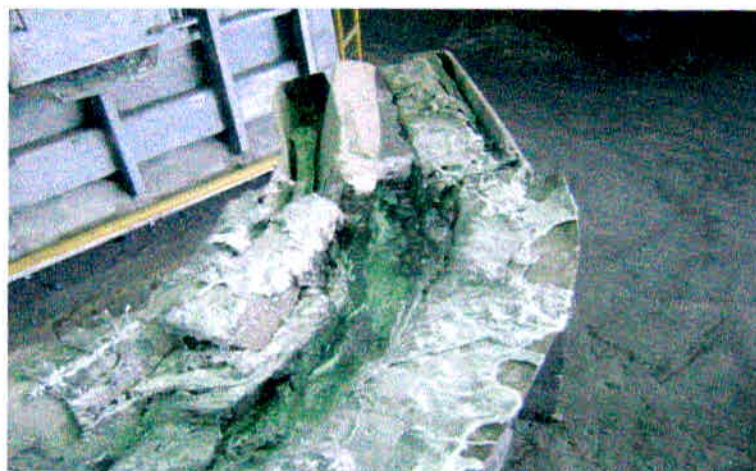
Foto 3 - Deformação das calhas
