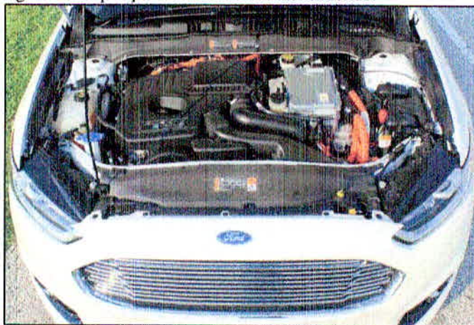
Figura 11: Disposição dos motores no Fusion Híbrido.
