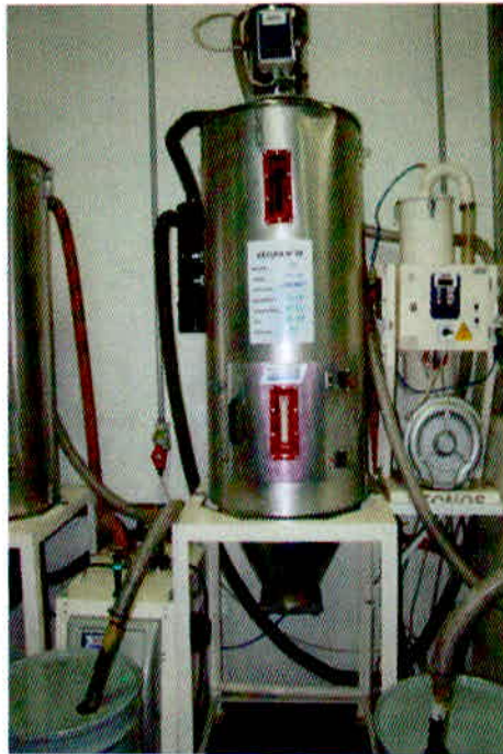
Foto 05: Estufa de matéria-prima para retirada de umidade do material. Fonte: Rafael José N. Rosa, 2011.
