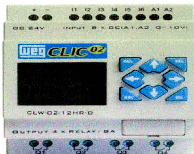
Figura 31: controlador logico programável
