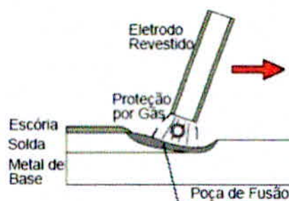
Figura 30: Processo de solda por eletrodo revestido
