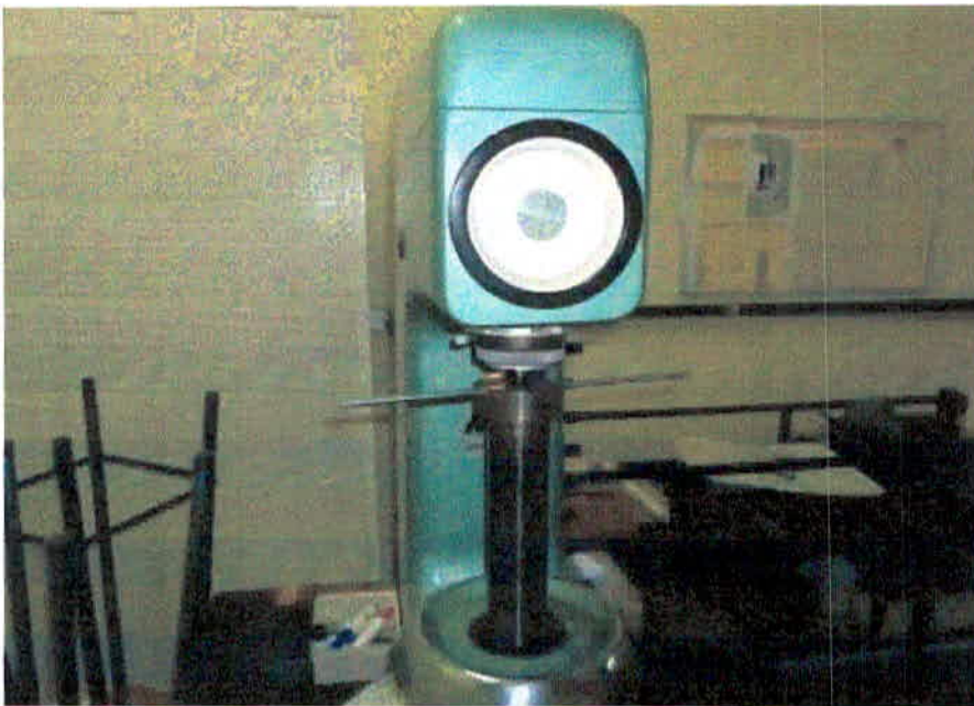
Figura 4: Durometro (equipamento para medir a dureza dos aços). Fonte: O autor
