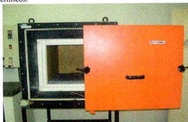
Figura 17: Forno tipo Câmara utilizado para os tratamentos térmicos.
