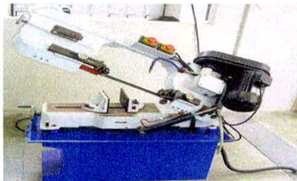
Figura 18: Serra de Fita utilizada para confeccionar os corpos de prova.
