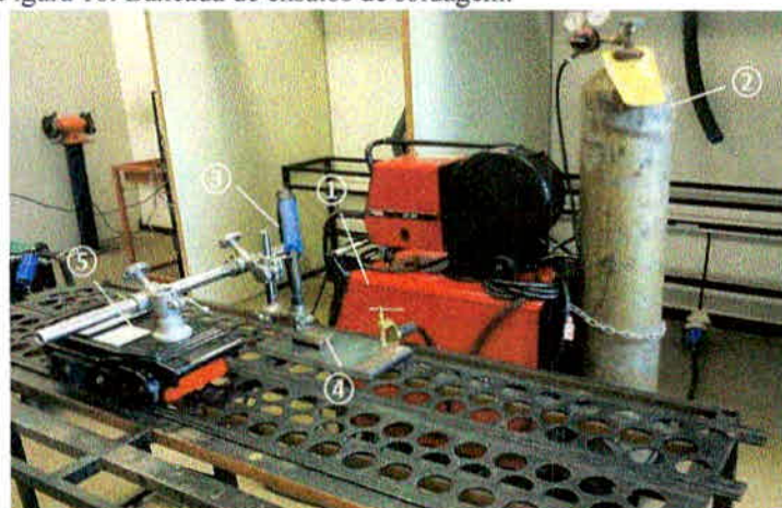
Figura 16: Bancada de ensaios de soldagem.
