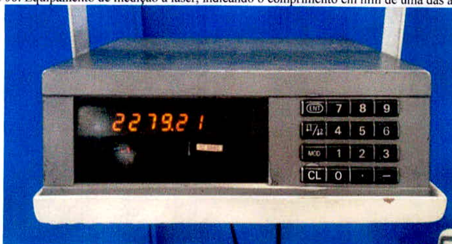
Figura 06: Equipamento de medição a laser, indicando o comprimento em mm de uma das amostras.
