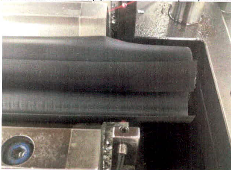
Figura 10: Perfil atual inserido no equipamento com sensores de presença na extremidade
