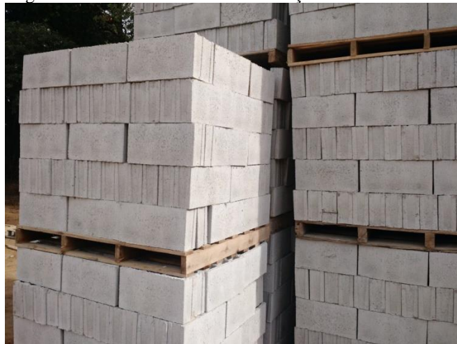
Figura 10 – Blocos utilizados na elevação.
