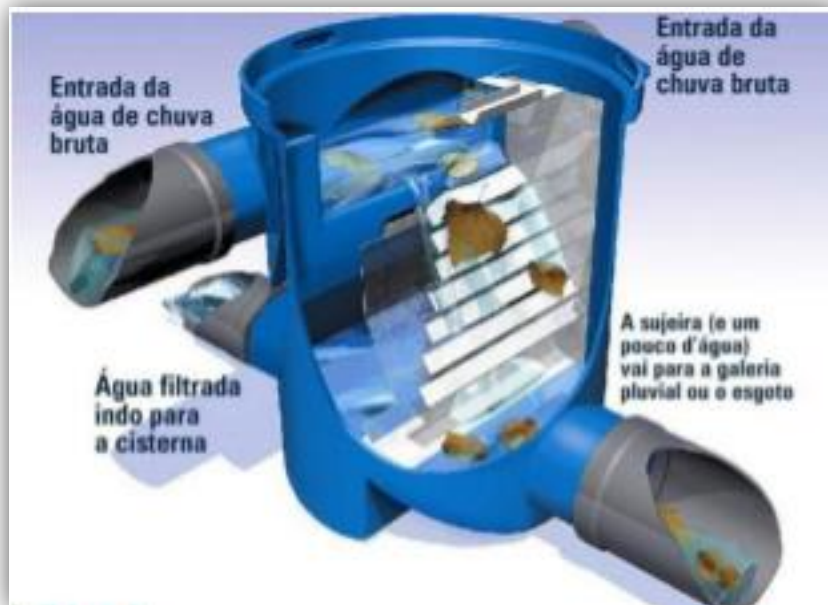
Figura 04: Esquema do equipamento de filtragem.
