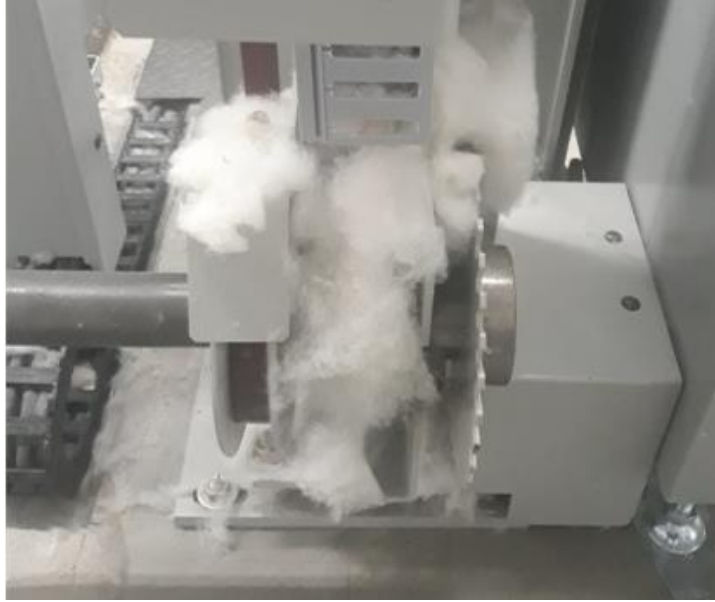
Figura 41: Região do sensor de pulso PRS250 após 20 dias, antes da instalação dos bicos injetores.
