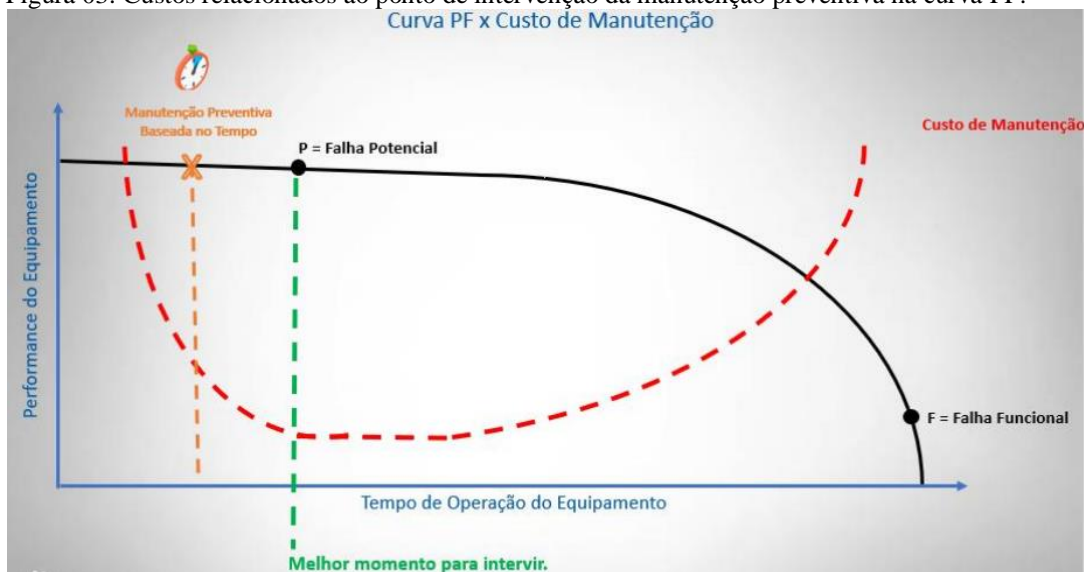
Figura 03: Custos relacionados ao ponto de intervenção da manutenção preventiva na curva PF.
