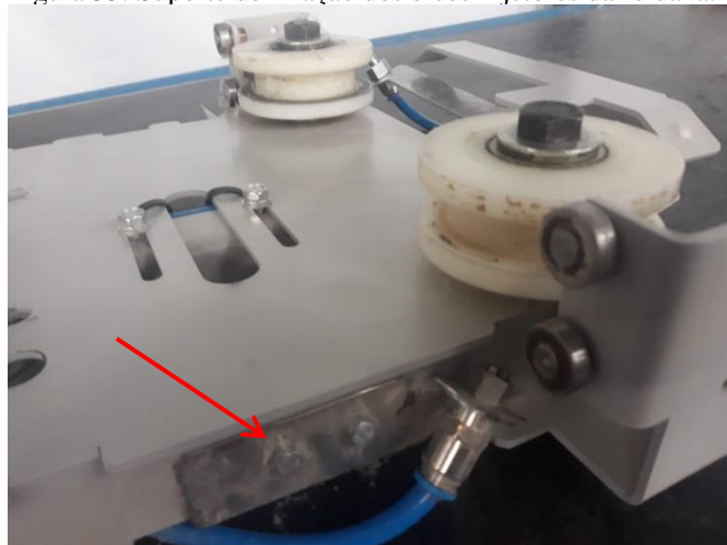
Figura 35: Suporte de fixação dos bicos injetores da roldana.
