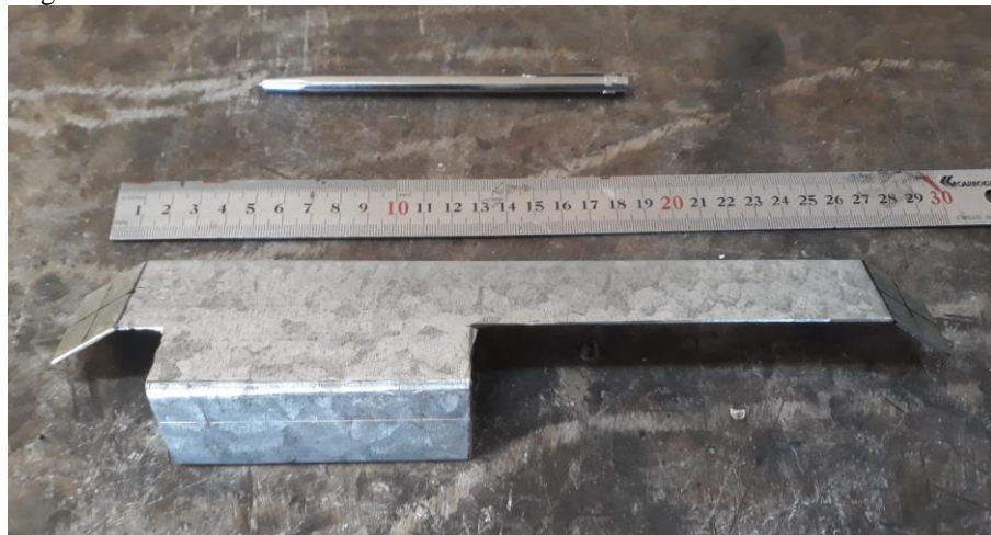
Figura 37: Suporte de fixação dos bicos injetores de limpeza dos sensores magnéticos.
