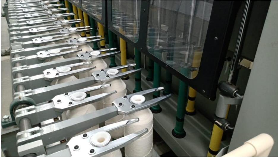
Figura 14: Retirada das bobinas cheias e inserção das bobinas vazias na máquina
