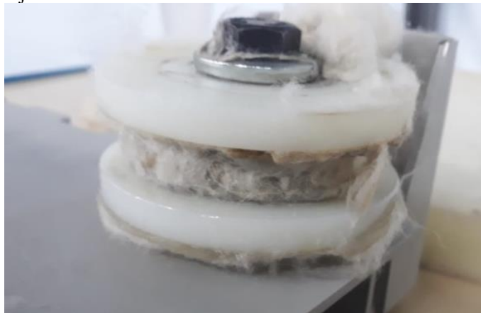
Figura 44: Acúmulo na roldana guia antes da instalação dos bicos injetores.
