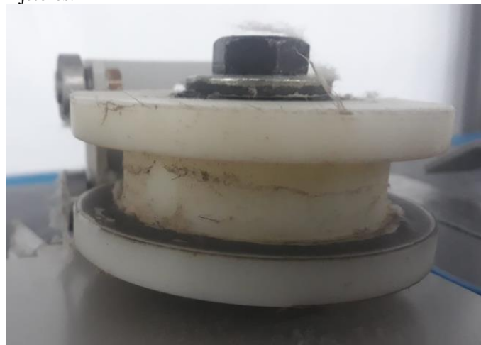
Figura 45: condição da roldana guia após a instalação dos bicos injetores.
