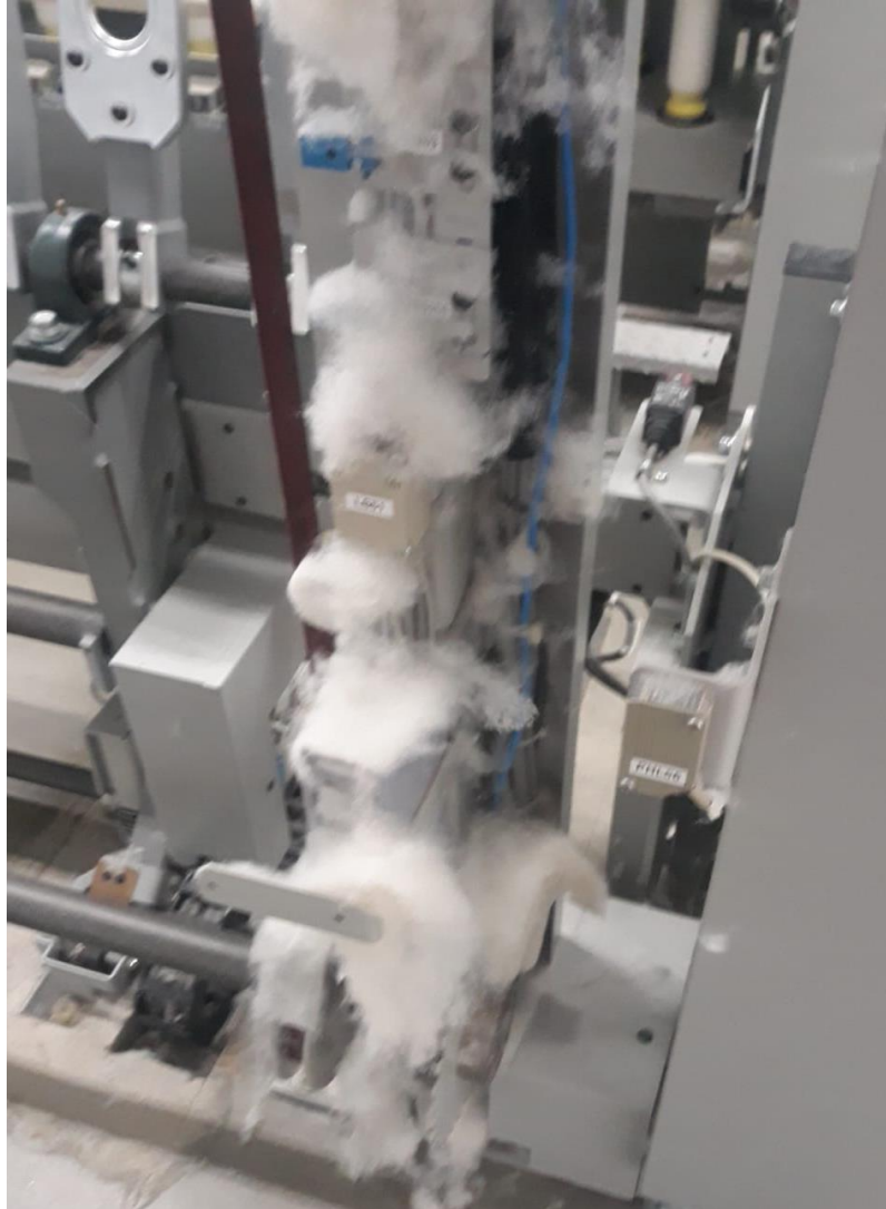
Figura 39: Região dos sensores de posicionamento após 20 dias, antes da instalação dos bicos injetores.
