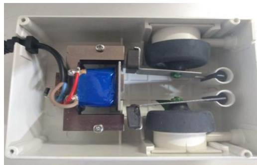
Figura 14. Parte interna compressor de ar
