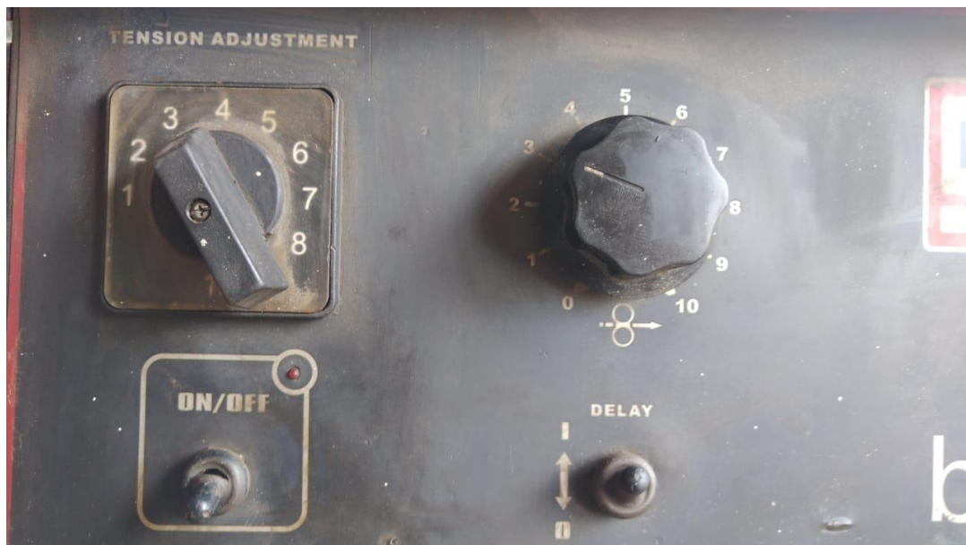
Figura 14: Regulagem da tensão e velocidade do arame
