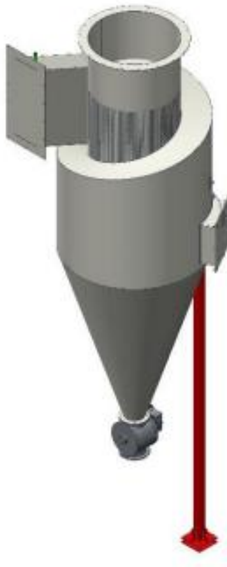
Figura 8: Ciclone do cilindro de torrefação.
