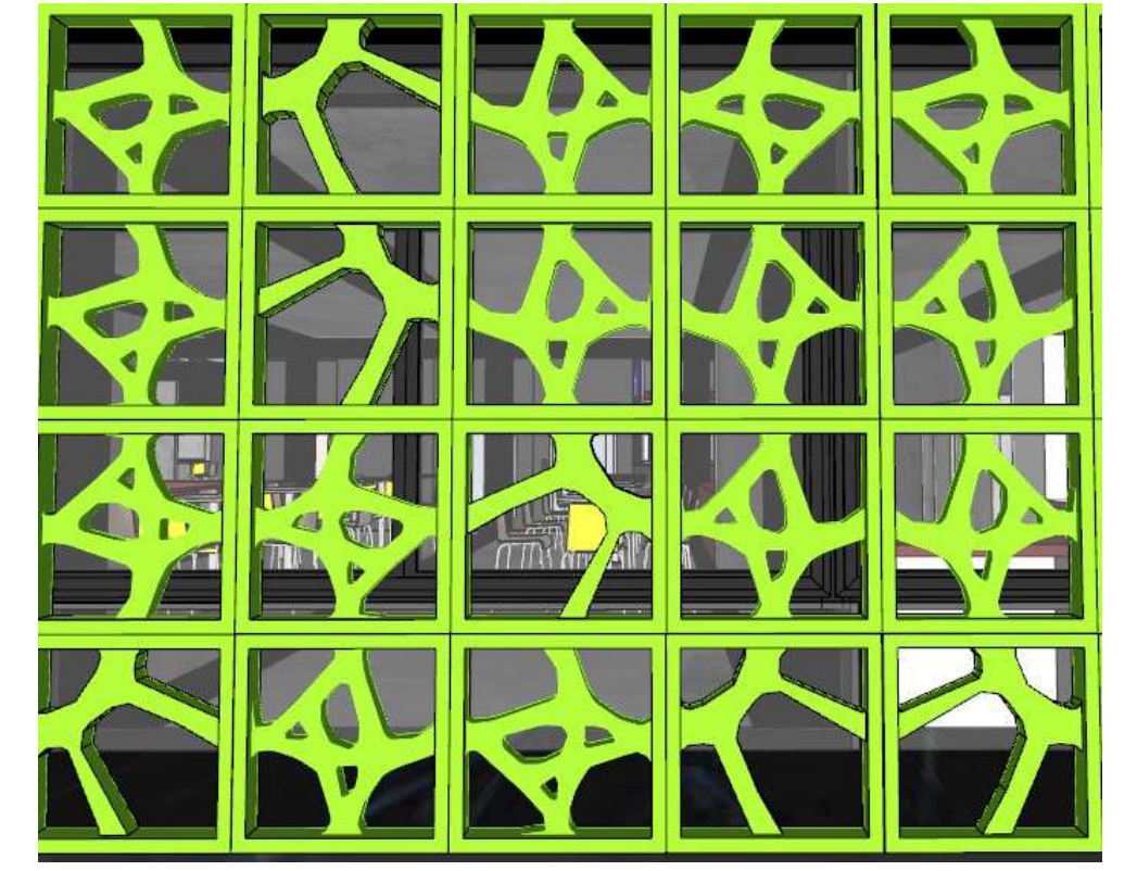
Cobogós paramétricos desenvolvidos exclusivamente para o projeto. O cobogó possui 3 desenhos orgânicos diferentes, que colocados de forma rotacionada e espelhada gera diferentes desenhos na composição. O elemento é importante pois controla a incidência solar e ainda mantém a permeabilidade visual, colabora com o ambiente pois quando o sol incide na fachada, gera sombras desenhadas dentro do Open Mall. São compostos de cimento, pó de PET (poli-terefalato de etileno) e areia. Dessa maneira colabora com o meio ambiente através da reciclagem.
