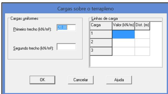
Figura 18 – interface do Gawacwin®, quadro Cargas sobre o terrapleno.
