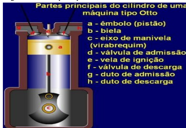
Figura 01: Partes principais do cilindro
