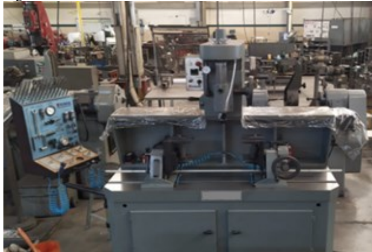
Figura 06: Fresadora de sede de válvulas
