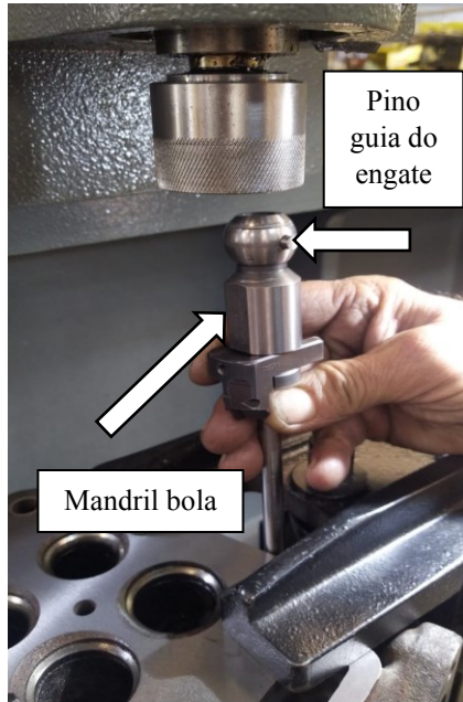
Figura 19: Colocação do mandril no eixo
