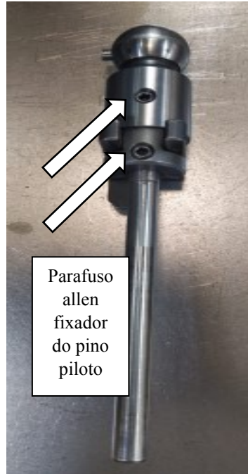
Figura 16: Pino piloto fixado no mandril bola
