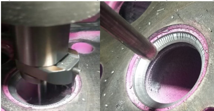
Figura 05: Sedes de Válvula com rugosidade na superfície em processo de usinagem
