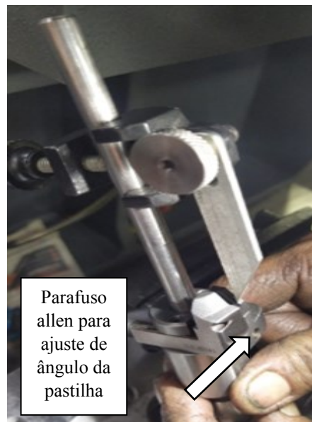
Figura 18: Regulagem do ângulo da pastilha
