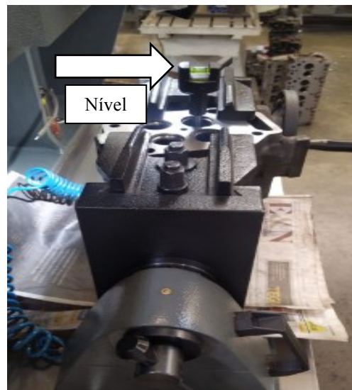
Figura 09: Nivelamento do cabeçote transversal
