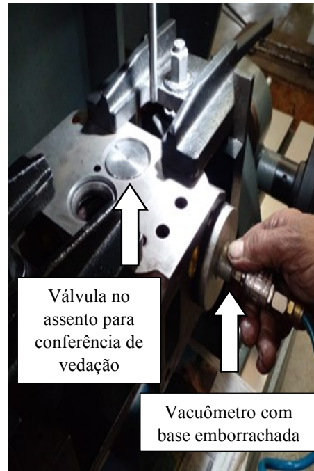
Figura 28: Cabeçote em teste de vácuo
