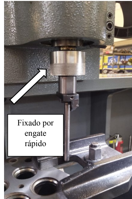
Figura 20: Fixação por engate rápido
