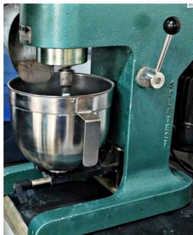
Figura 12 – Adição do cimento no misturador mecânico
