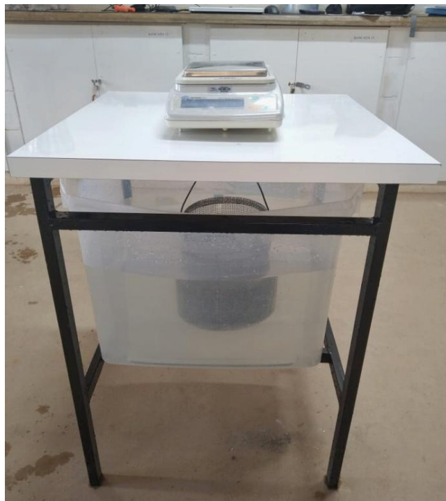
Figura 9 – Procedimentos para obtenção da massa específica do agregado
