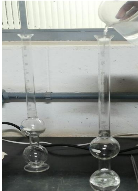
Figura 10 – Frasco de Chapman utilizado no ensaio de massa específica do cimento
