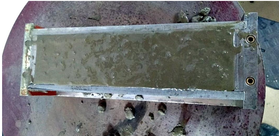
Figura 19 - Prisma após o processo de moldagem.
