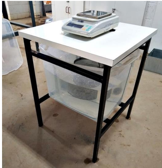
Figura 11 - Procedimento para obter os valores de massa específica e massa específica aparente.
