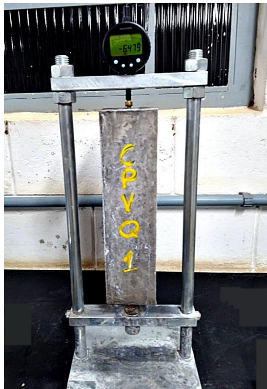
Figura 22 - Medição de variação de comprimento em prisma de concreto.
