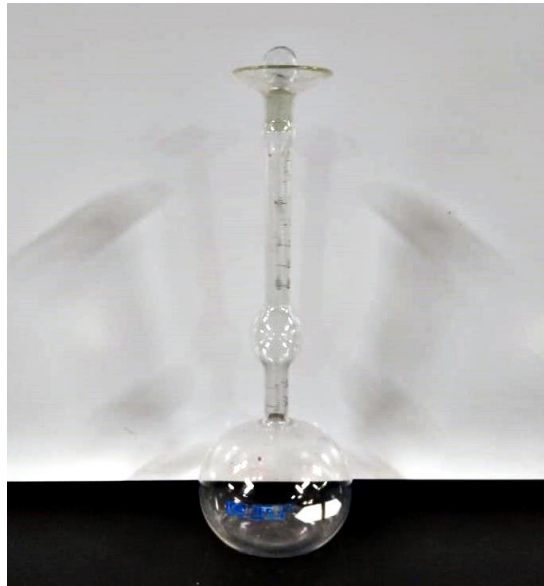
Figura 16 - Frasco de Le Chatelier utilizado para ensaio de massa específica do cimento.
