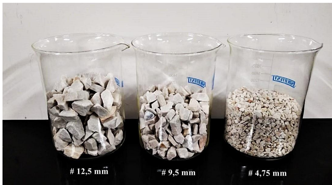
Figura 13 - Separação granulométrica do agregado graúdo.
