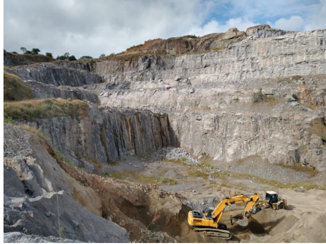
Figura 07 – Bancadas de exploração do gnaiss na área da Fazenda Ribeirão Santana.
