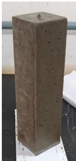
Figura 20 – Prisma recém desenformado.
