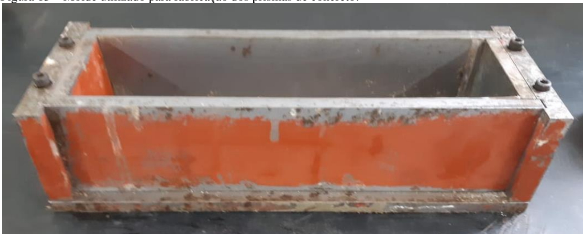
Figura 13 – Molde utilizado para fabricação dos prismas de concreto.
