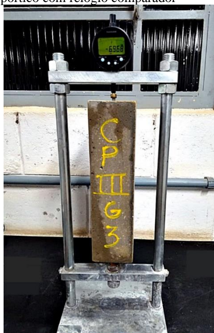
Figura 21 – Leitura sendo realizada no pórtico com relógio comparador
