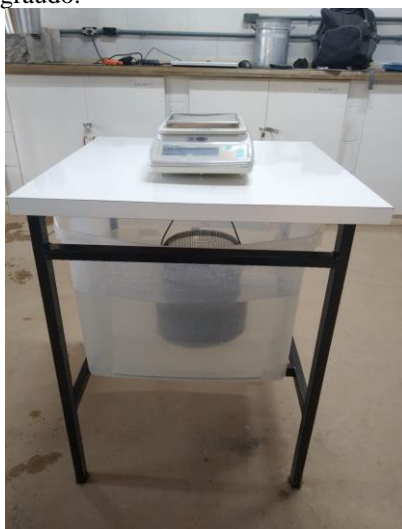
Figura 10 – Realização do ensaio para obtenção dos valores de massa específica, massa específica aparente e absorção de água do agregado graúdo.
