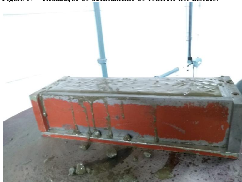
Figura 17 – Realização do adensamento do concreto nos moldes.
