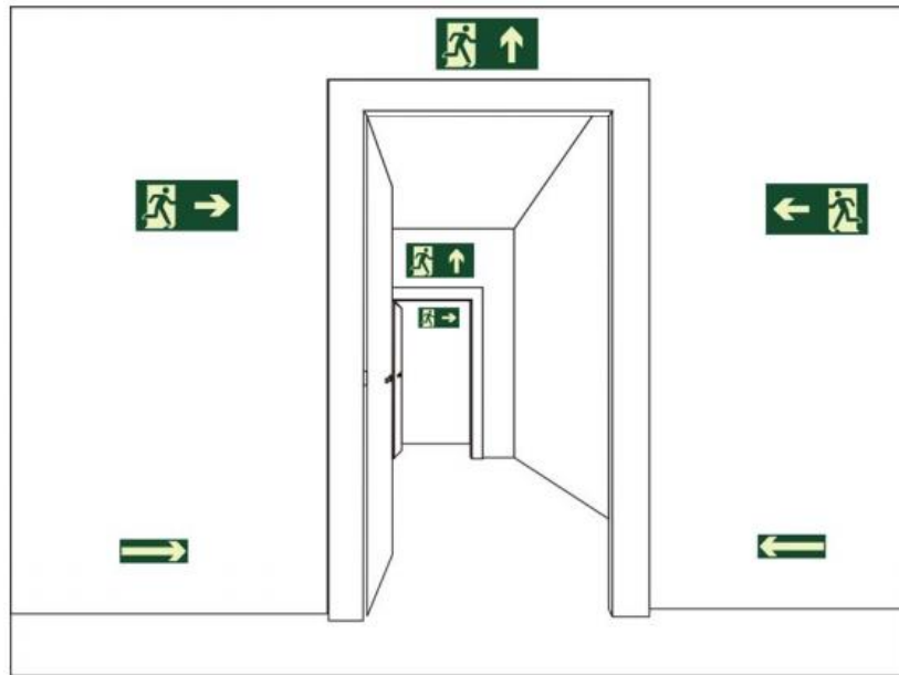
Figura 9 - Sinalização de saída sobre porta corta-fogo - Sinalização complementar de saída e obstáculos
