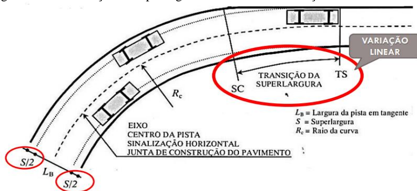
Figura 20 - Distribuição da superlargura numa curva de transição
