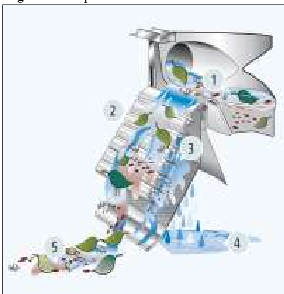
Figura 15: Esquema do funcionamento do filtro
