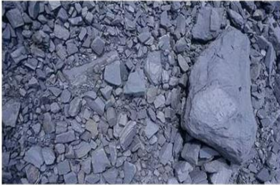
Figura 4 - Agregados artificiais (xisto expandido).
