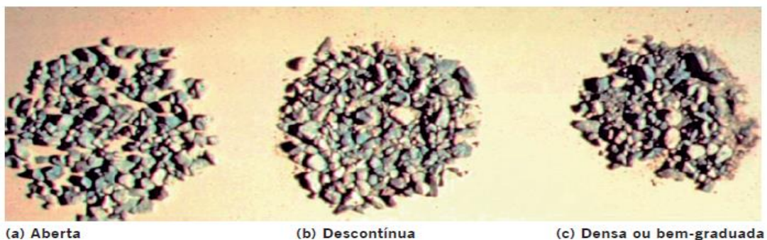
Figura 6 - Composição granulométrica dos tipos de misturas a quente.
