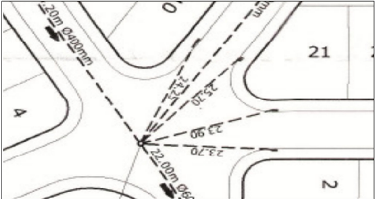
Figura 21 – Ligações excessivas no poço de visita
