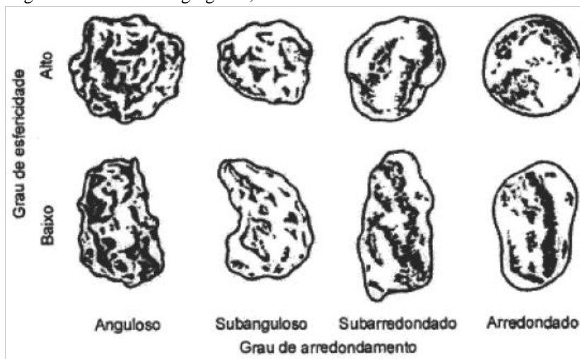
Figura 5 - Forma dos agregados, conforme NBR 7389:2009
