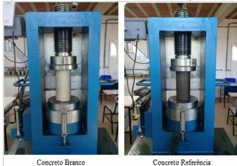
Figura 34 - Prensa usado no ensaio de resistência a compressão
