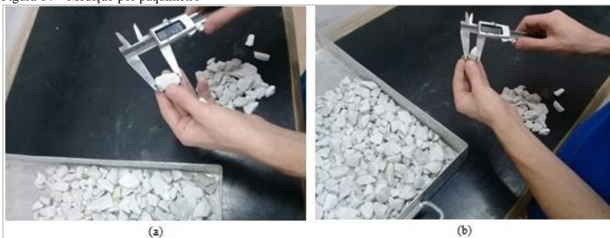
Figura 14 – Medição por paquímetro
