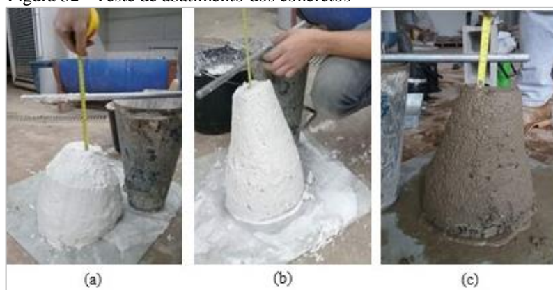
Figura 32 - Teste de abatimento dos concretos
