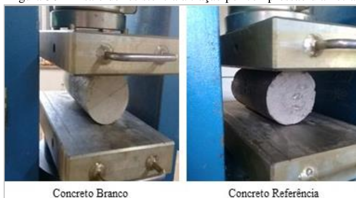
Figura 36 - Ensaio de resistência à tração por compressão diametral
